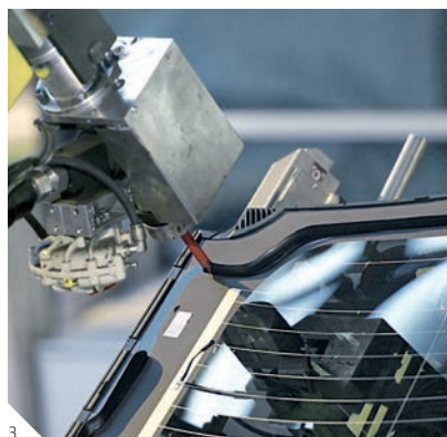
1 Sikaflex®を使用して接着された パノラマルーフモジュール 2 SikaForce®を使用して接着されたサンルーフ 3 Sikaflex®を使用して接着されたガラス
