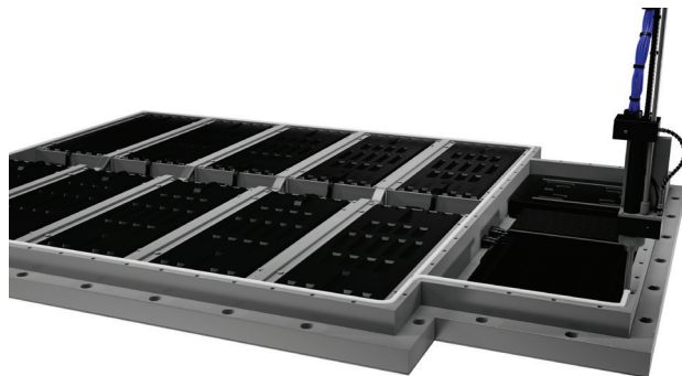
シーリングの塗布
