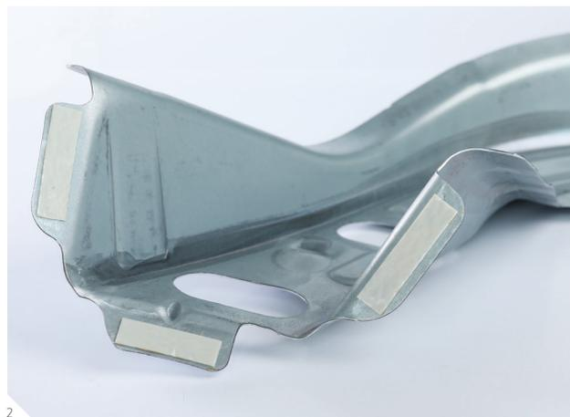
2 構造用接着剤の代わりに貼り付けた押出成型の構造用テープ
